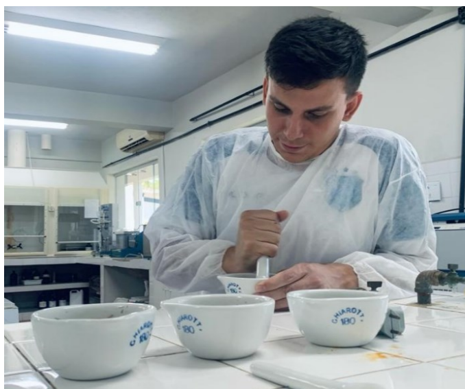
Figura 10. Processo de maceração da silagem em água destilada para análise de nitrogênio amoniacal.
