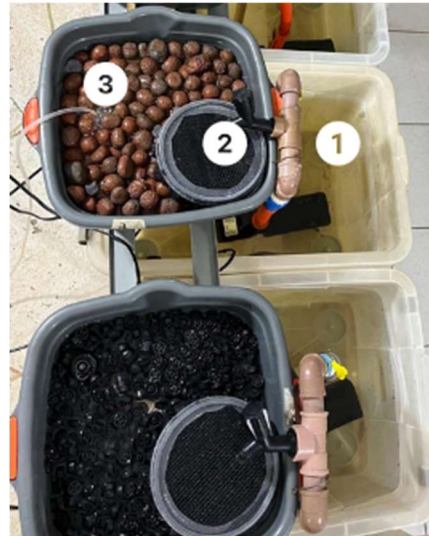
Figura 3. Unidades experimentais do sistema de recirculação em aquicultura (RAS).
