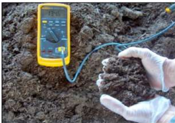
Figura 18a e 18b: Compostos com temperatura adequada e material seco, 18a (134,6 °F = 57 °C) e 18b (132,9 °F = 56 °C).
