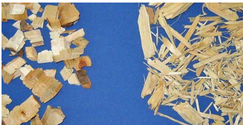
Figura 14: Lascas de madeira produzidas com laminas afiadas (esquerda) e martelo sem corte (direita) madeira
