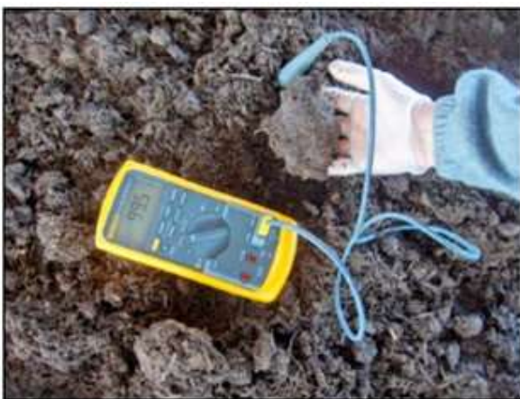
Figuras 19a e 19b: Composto muito úmido e com temperatura insuficiente 19a (99,5 °F = 37,5 °C) e 19b (79,6 °F = 16 °C).
