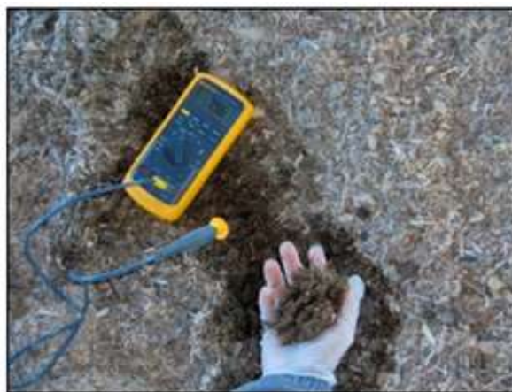
Figuras 19a e 19b: Composto muito úmido e com temperatura insuficiente 19a (99,5 °F = 37,5 °C) e 19b (79,6 °F = 16 °C).
